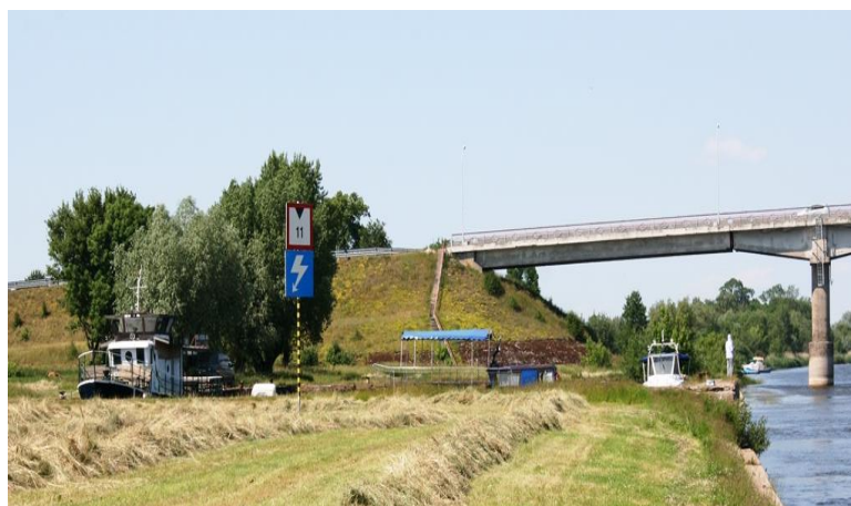
123 pav. Navigaciniai ženklai informuojantys apie laivybos kliūtis Atmatoje – tiltą ir elektros perdavimo linijas. Pastarasis ženklas įrengtas jau praplaukus laidus. E. Spiriajevo nuotrauka.
